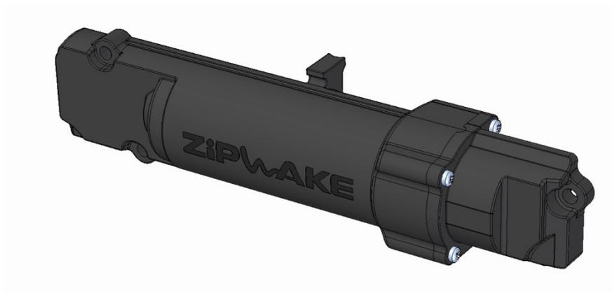
El motor eléctrico es sumergible y va ubicado dentro del interceptor, desde donde mediante un preciso mecanismo, controla el movimiento lineal de los interceptores. La unidad es de rápida actuación, libre de calibración y fácil de instalar o reemplazar. Se incluye con un cable de 3 metros con sistema de autosellado y pasacascos.
